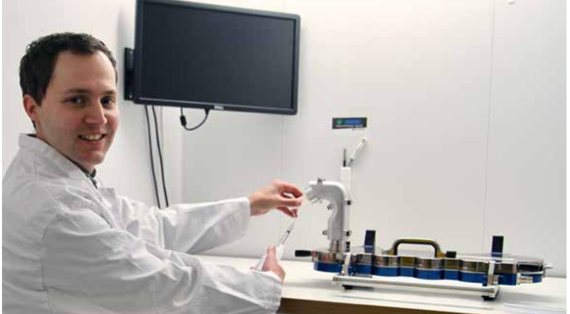
Product manager Frank Verhoeven demonstreert een longmodel, waarbij de afzonderlijke compartimenten corresponderen met verschillende 'dieptes' in de longen.
