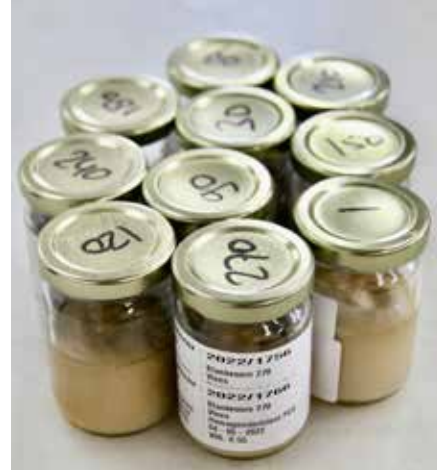
Na sterilisatie vindt op een selectie van tien potjes uit de batch van 270 een homoginiteitstest plaats.
